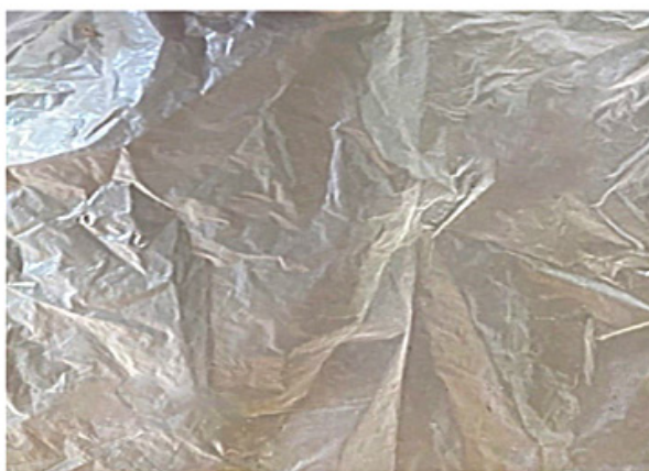
Пленка PLA/PBAT УФ облученная после 120 дней компостирования
