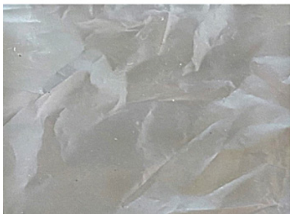
Пленка PLA/PBAT УФ облученная до компостирования
